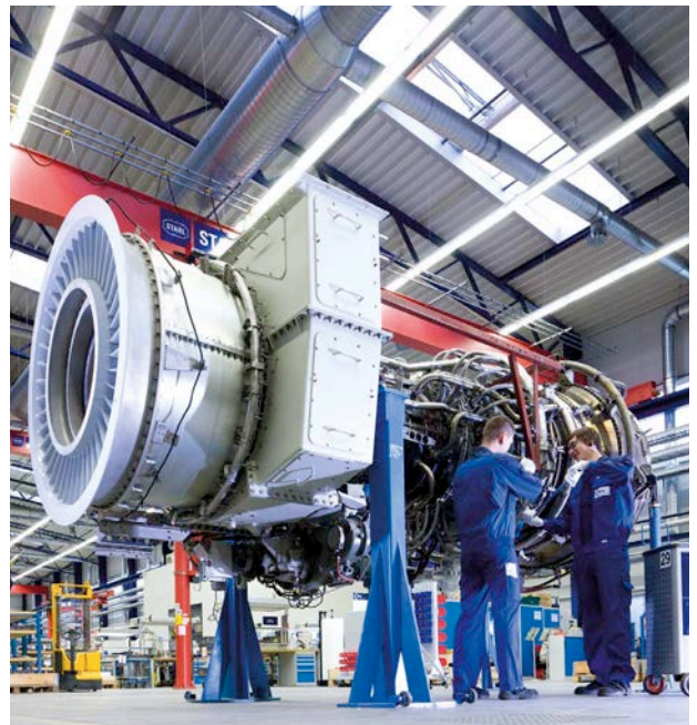
Montage einer LM6000-Industriegasturbine bei MTU in Ludwigsfelde
